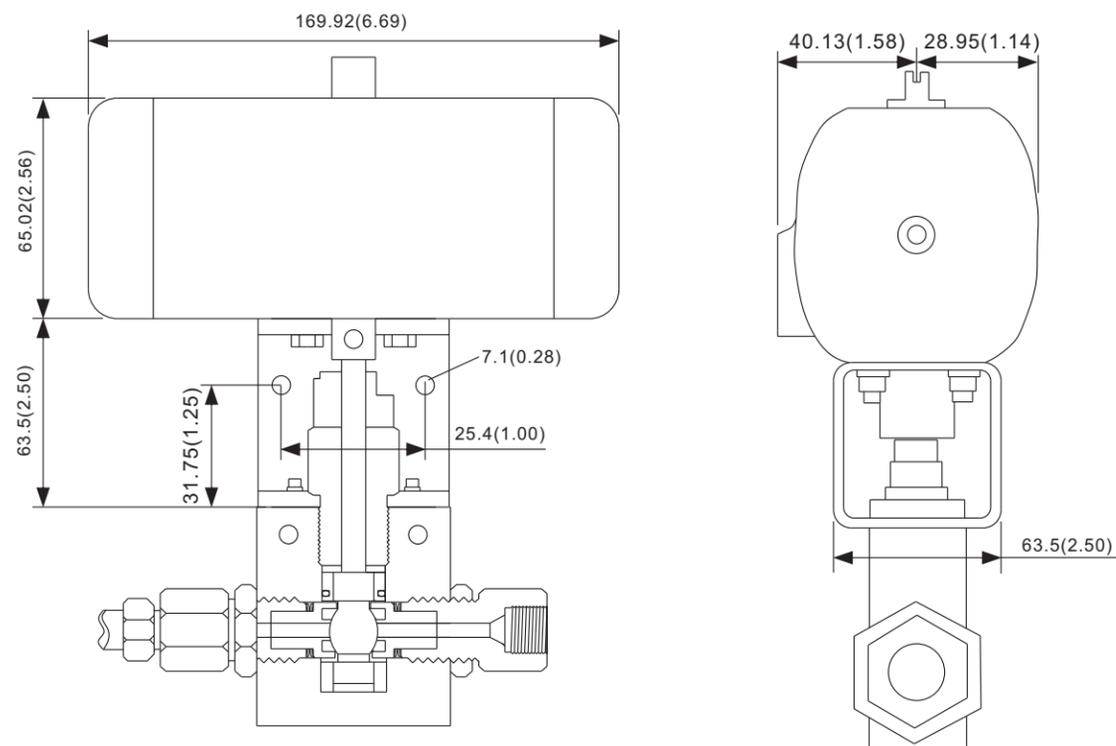
Размеры привода указаны на рисунке. Размеры корпуса клапана см. стр. 15 и стр. 16.
