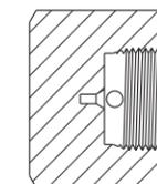
1. MF означает соединение с внутренней резьбой среднего давления. HF означает соединение с внутренней резьбой высокого давления.
